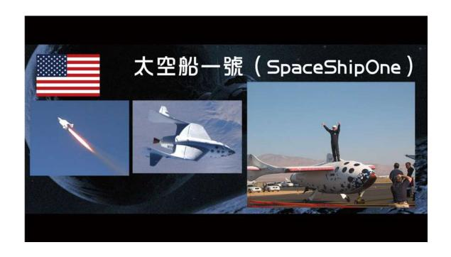
它使用「混合式固體火箭引擎」,有雙尾翼以及可變的半三角翼機翼,在不同的階段,機翼會變成不同的狀態。太空船一號並不是以運載火箭發射升空,而是先由另一架飛機名為「白色騎士號」載上高空後才開始自行飛行。
