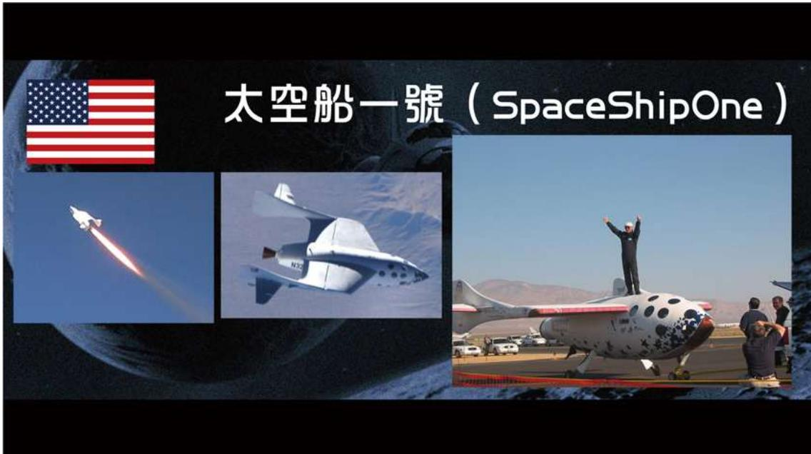
它使用「混合式固體火箭引擎」，有雙尾翼以及可變的半三角翼機翼，在不同的階段，機翼會變成不同的狀態。太空船一號並不是以運載火箭發射升空，而是先由另一架飛機名為「白色騎士號」載上高空後才開始自行飛行。
