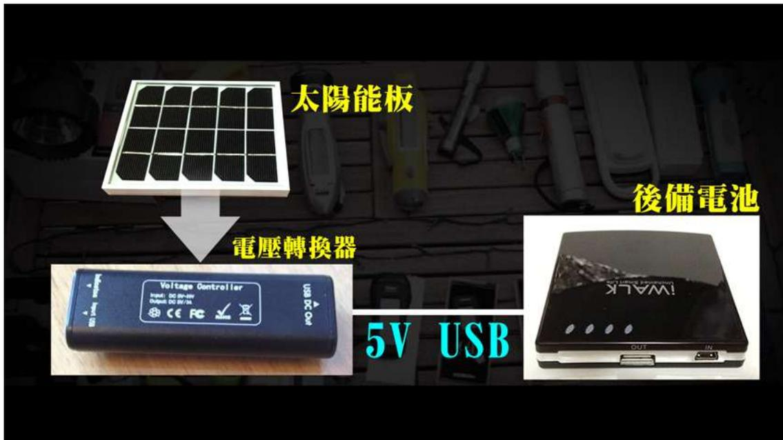
市面上，有不同的後備電池。近年有一些較新設計能夠具備「自動斷電」技術的後備電池，意思是，當後備電池為到電子產品 100% 充滿後，便會自動斷電，而保護後備電池和電子產品的壽命，就如畫面所見兩款的型號
