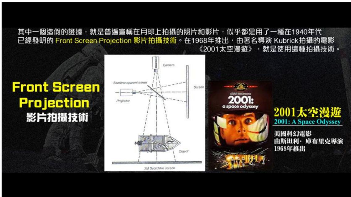
Front Screen Projection 是一個非常簡單的方法，只需在一個室內的廠景攝影棚內，利用投影機所投影的影像，加上一個非常高反光度的投影幕 Scotchlite，及一塊一面是鏡子、另一面是透明的分光鏡，就可以在鏡頭下拍出一個室外的場境。
