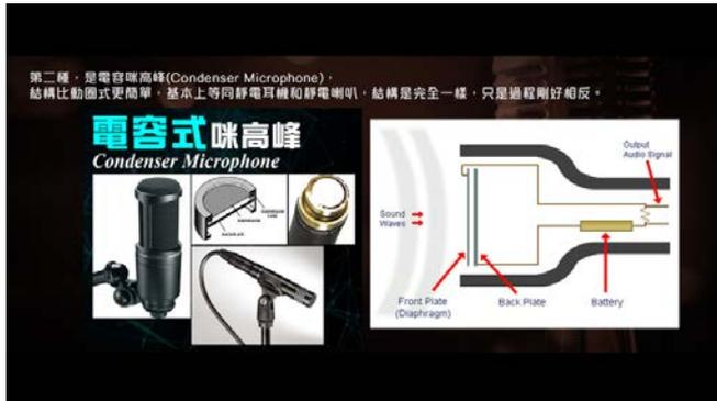
簡單而言，電容麥克風是由一片帶電的振膜，和另一片帶電的固定金屬片組成，當聲音振動振膜的時候，振膜與金屬片之間的距離就會產生變動，從而產生電子訊號。
