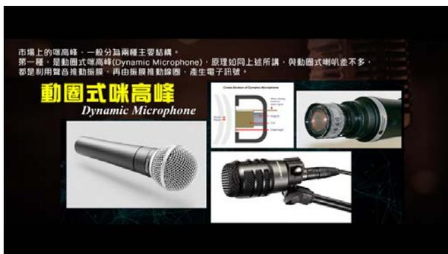
只是，動圈式麥克風的線圈，對比動圈式喇叭，長十倍至一百倍，從而產生更大電阻，將振動產生的訊號擴大，令收錄的聲音減少雜訊。
