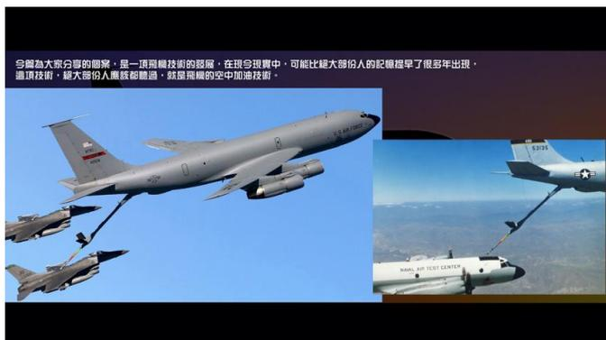
空中加油是飛機快要用盡機上儲存的電油時，由另一架空中加油機，從上方放下一條油管，雙方以非常高超的駕駛技術，控制油管順利插入油缸中加油。
